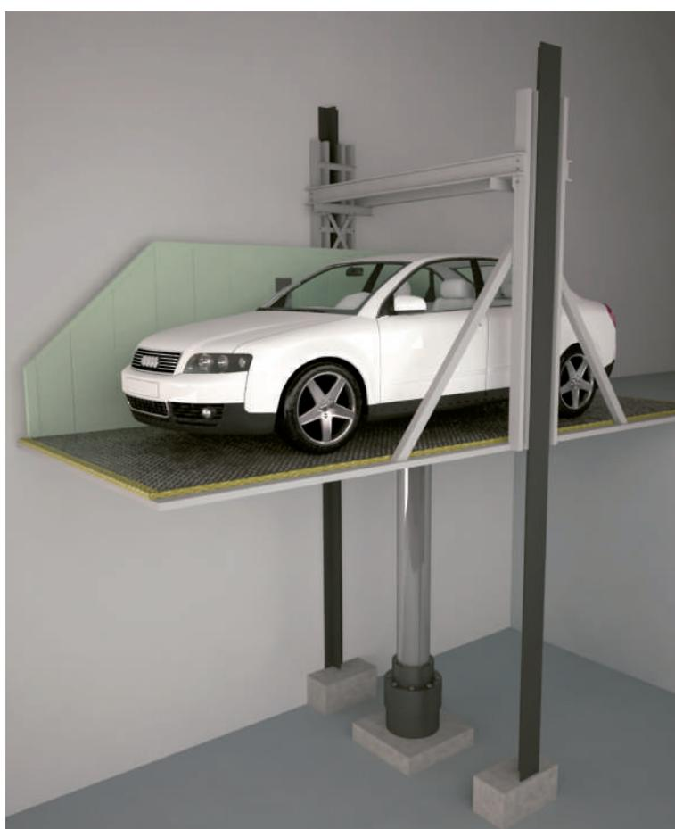
*CUENTA CON TODAS LAS MEDIDAS DE SEGURIDAD DISPONIBLES. EL CONTROL ELECTRÓNICO DE ÚLTIMA GENERACIÓN COMANDA EL EQUIPO HIDRÁULICO HACIENDO SUBIR O BAJAR LA PLATAFORMA, COORDINANDO SU MOVIMIENTO CON LOS PORTONES AUTOMÁTICOS DE ACCESO. LA PLATAFORMA PUEDE SER MOVIDA POR UN PISTÓN HIDRÁULICO CENTRAL ENTERRADO DE ACCIONAMIENTO DIRECTO .*
