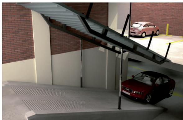
*RAMPA FIJA: PENDIENTE MÁXIMA DEL 20%, ANCHO MÍNIMO DE 3,00 METROS, CONVENIENTEMENTE AMPLIADO EN LAS CURVAS PARA SEGURIDAD DE LOS VEHÍCULOS.*
